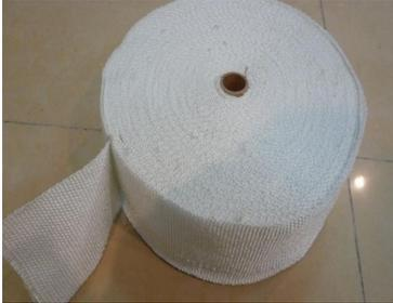
陶瓷纖維帶为绝缘材料是石棉带的理想替代品，常用于高温电绝缘电缆、电线防护，高温管道保温。
